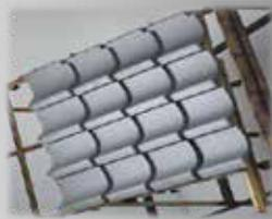
银熏瓦是一种粘土瓦，制造过程中不涂上釉药，用烟熏。把粘土烧成后，满燃料（煤油，LPG，LNG）这些燃料进行热分离，游离的碳粘着在表面上，形成碳膜。银熏瓦如此做出优美的银色。
